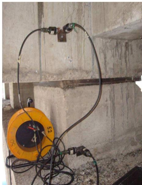
Figura 1. Strumentazione della prova di caratterizzazione dinamica del viadotto
