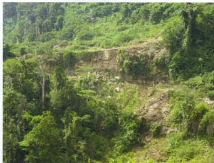
Fig. 7 - Fenomeni di "toppling" dalle bancate di arenaria sul sito della spalla nord del viadotto
